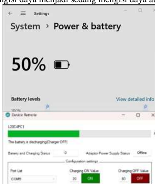
Gambar 12. Pengujian kontrol tombol off pada software
