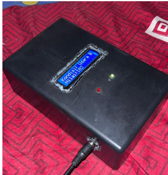
Gambar 5 Sistem pendeteksi kebocoran gas LPG saat pengujian berlangsung
