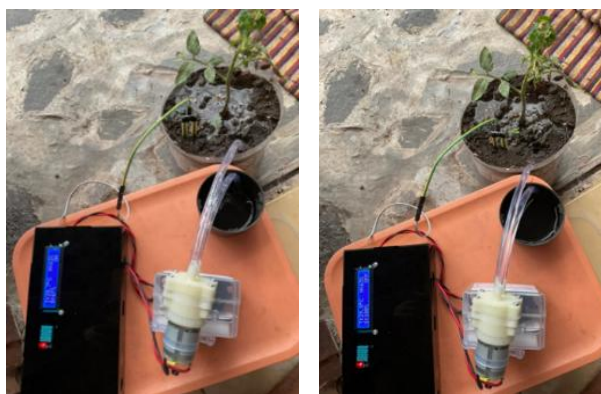
Gambar 7 Foto Pengujian Relay dan Pompa Air
